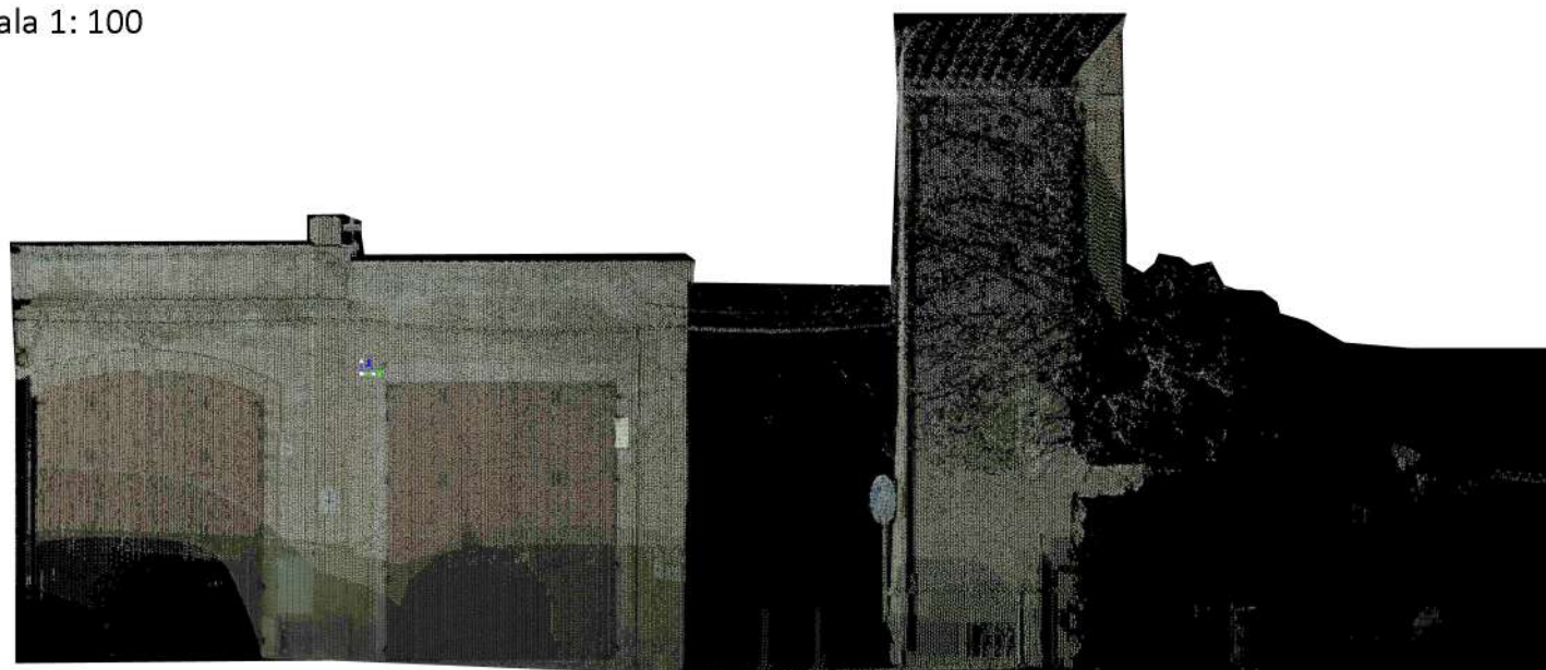
Prospetto interno edifici n. 15-16-17-18 Rilievo laser LEICA ScanStation C10
