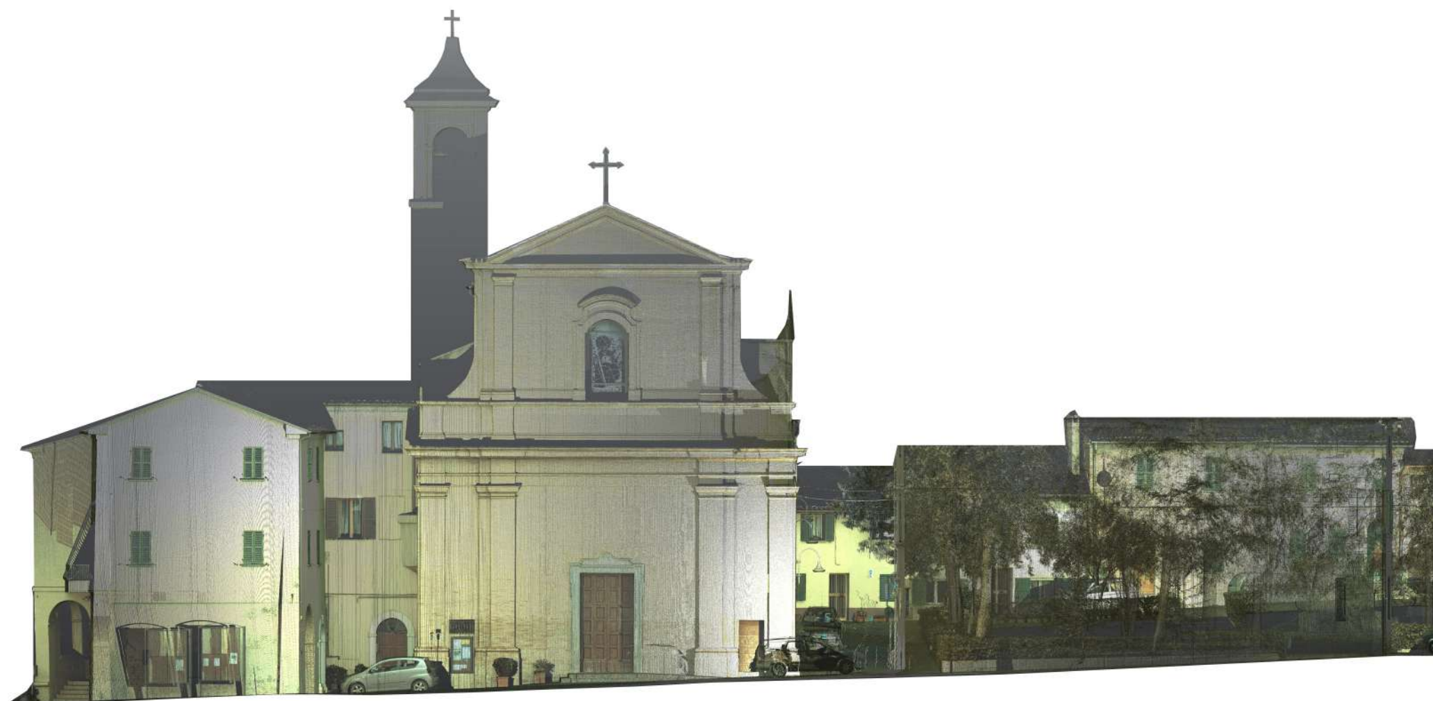
Prospetto interno edifici n. 28-29-30-37 Rilievo laser LEICA ScanStation C10
