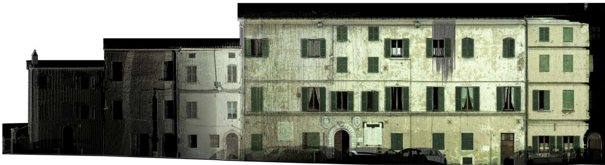
Prospetto interno edifici n. 21-22-23-24 -25 Rilievo laser LEICA ScanStation C10
