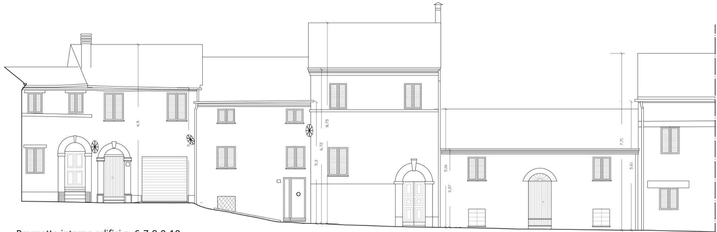
Prospetto interno edifici n. 6-7-8-9-10 Stato Attuale scala 1:100
