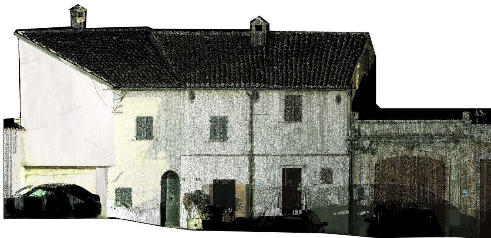
Prospetto interno edifici n. 15-16-17-18 Rilievo laser LEICA ScanStation C10
