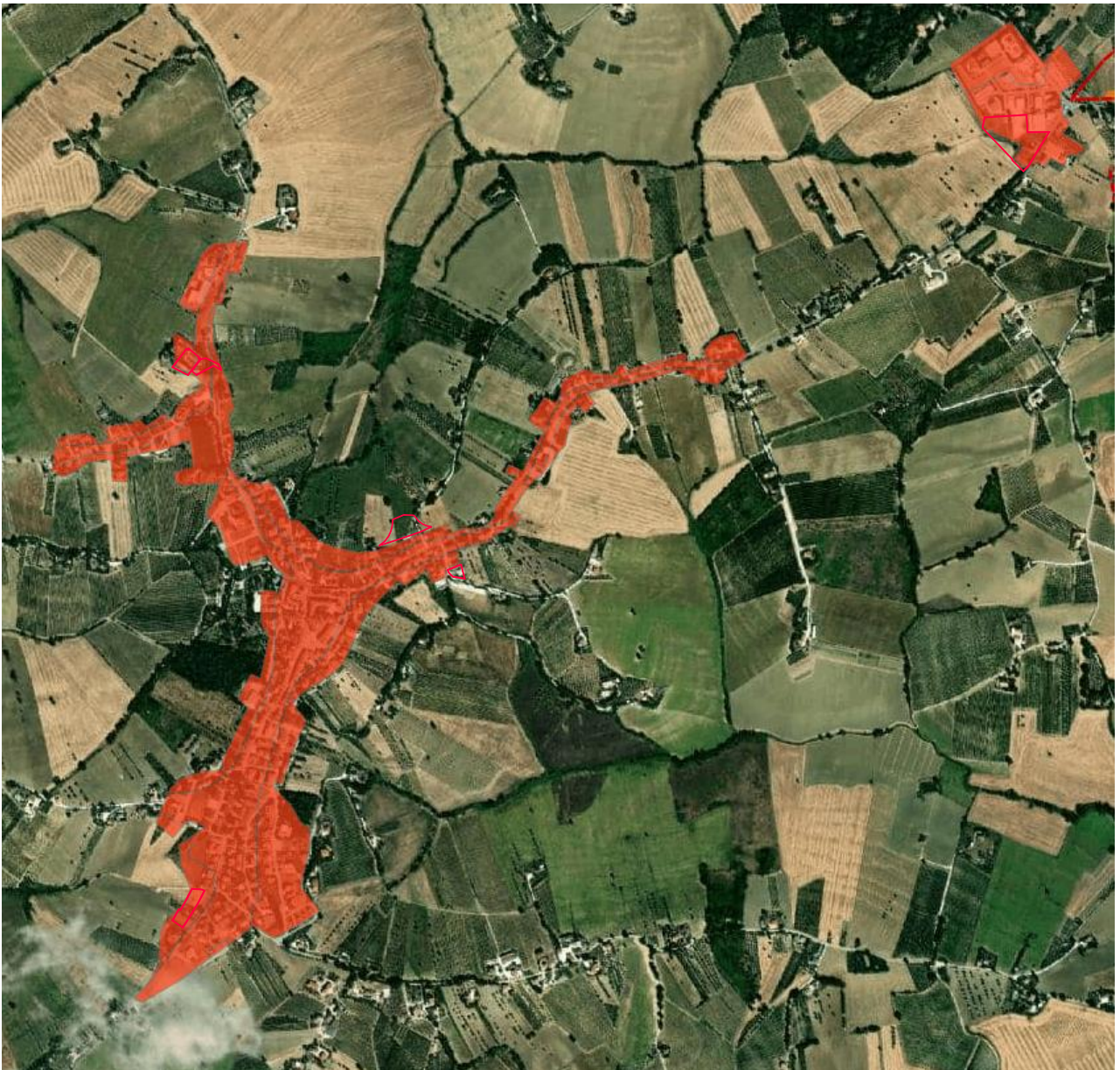
Figura 20 - stralcio della cartografia di Microzonazione Sismica di II livello con indicazione (in rosso) dell'area in variante: microzona con amplificazione FA= 1,9 per periodi di vibrazione degli edifici compresi tra 0,4s e 0,8s.
